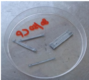
Fibre anticorrosione, prova superata
