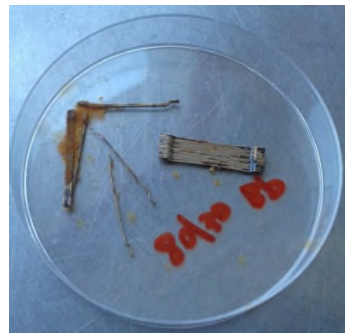
Fibre corrodibili, prova non superata
