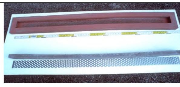
Fig. 4 - Tipico comportamento concavo di una malta che ritira all'aria
